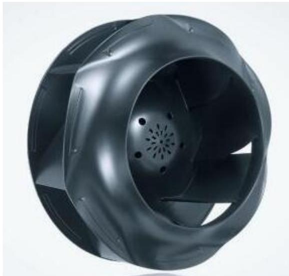
前倾与后倾的离心风机主指装配风机的叶片不同，前倾式一般称为鼓风机，后倾式一般称为引风机，其区别是叶轮横档和叶轮边缘的长度。
